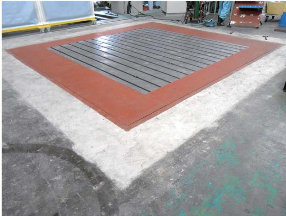
振動テスト／組立定盤 K社様（大阪府枚方市）
