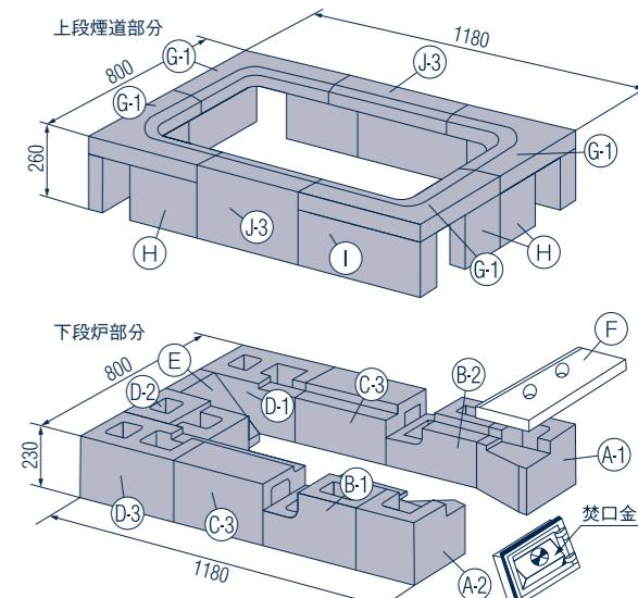
施工に際し、図に基づいて正しく据付してください。※ 部分は築炉部分を示します。
