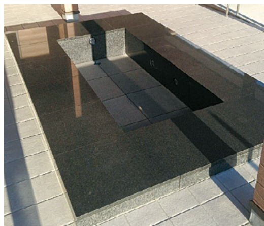
仕様／框・内側：黒御影石 サイズ／2,800×1,800×H423mm（内寸 1,848×848×H355mm）
